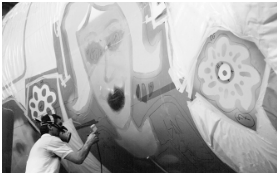
Flugzeuge werden alle sechs bis neun Jahre generalüberholt, dabei wird auch die Lackierung komplett erneuert. In diesem Fall hat der New Yorker Maler und Bildhauer James Rizzi eine phantasievolle Sonderbemalung für eine Boeing 757 entworfen. Das fliegende Kunstwerk erhielt den Namen Rizzi-Bird
