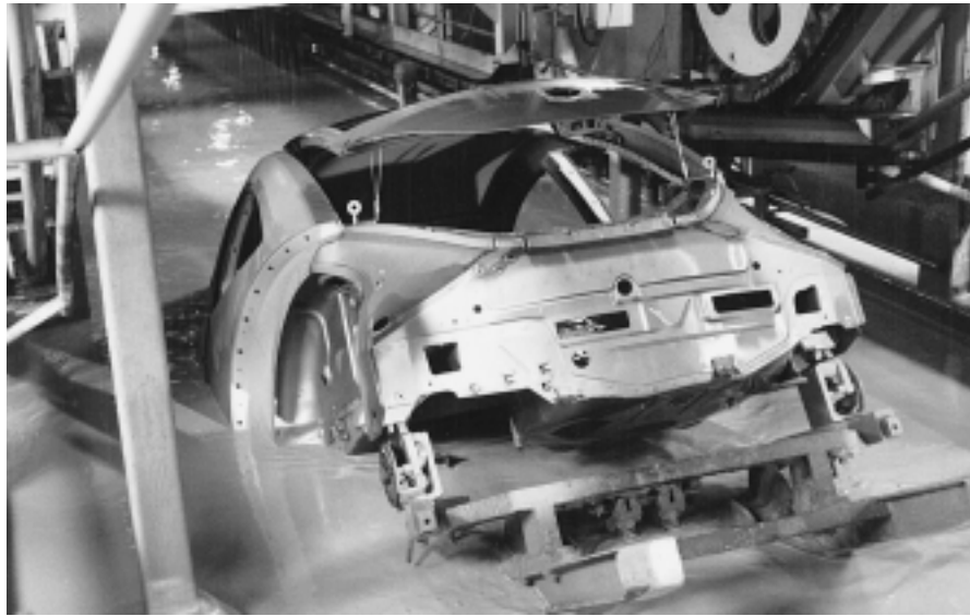
Die Aufbringung des Korrosionsschutzes bei Autos erfolgt durch die kathodische Elektrotauchlackierung (KTL)
